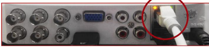
Se conecta el equipo a la corriente, video y a la red a través de un cable de ponchado con salida RJ45, se debe verificar que el cable este dando ping (parpadeo intermitente del led en el puerto RJ45).
